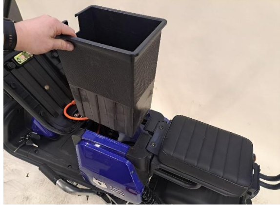
Nosta akkukotelo pois.
