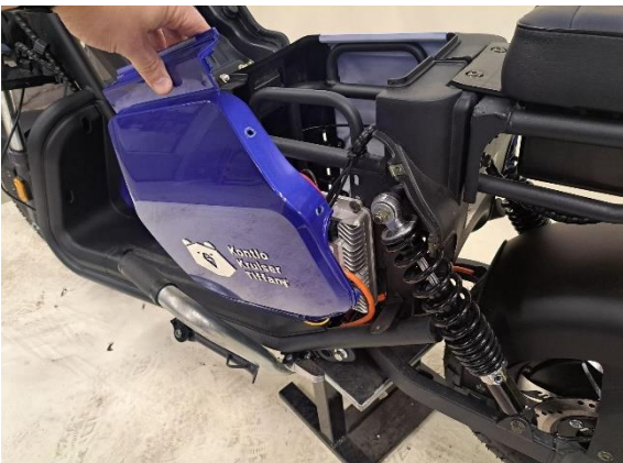
Ota istuimen vasemmanpuoleinen alasivumuovi pois.
