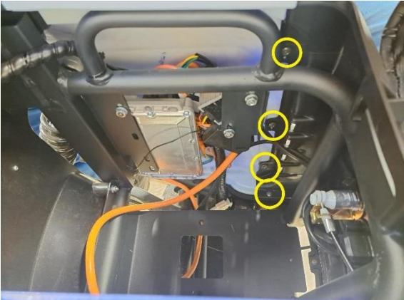
Irrota istuimen vasemmanpuoleisen alasivumuovin kiinnitysruuvit (ristipäämeisseli ph2).
