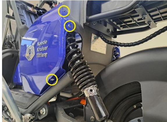
Irrota istuimen vasemmanpuoleisen alasivumuovin kiinnitysruuvit (ristipäämeisseli ph2).
